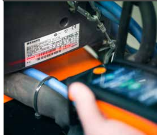
ArcValidator RC enregistre les données du processus de validation complet pour les transférer ultérieurement au logiciel sur PC.
