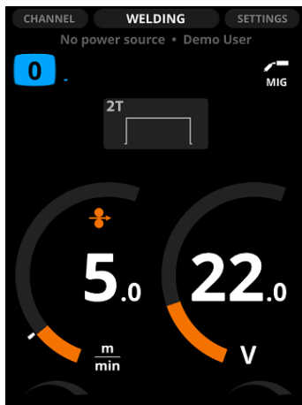
Figur: Visning av MIG-sveising
