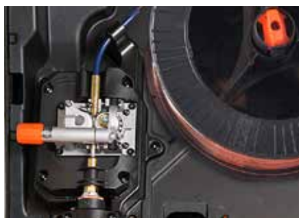
Modele Kempact 251 posiadają 2-rolkowy mechanizm podający GT02C.
