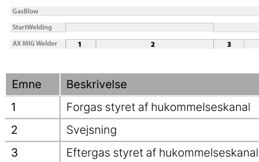
Figur 1: Før- og eftergas styret af hukommelseskanal
