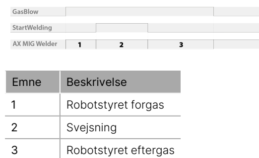
Figur 2: Robotstyret for- og eftergas
