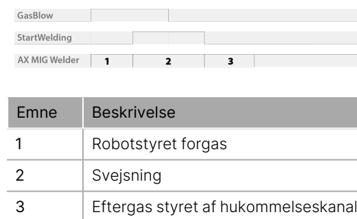
Figur 3: Robotstyret forgas og hukommelseskanalstyret eftergas
