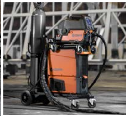
Den fyrhjuliga trådmatarverksvagnen har en snabbkopplingsdesign som gör det enkelt att koppla ihop den ovanpå den vanliga X5 FastMig-strömkällan vilket ger säker förvaring och transport.
